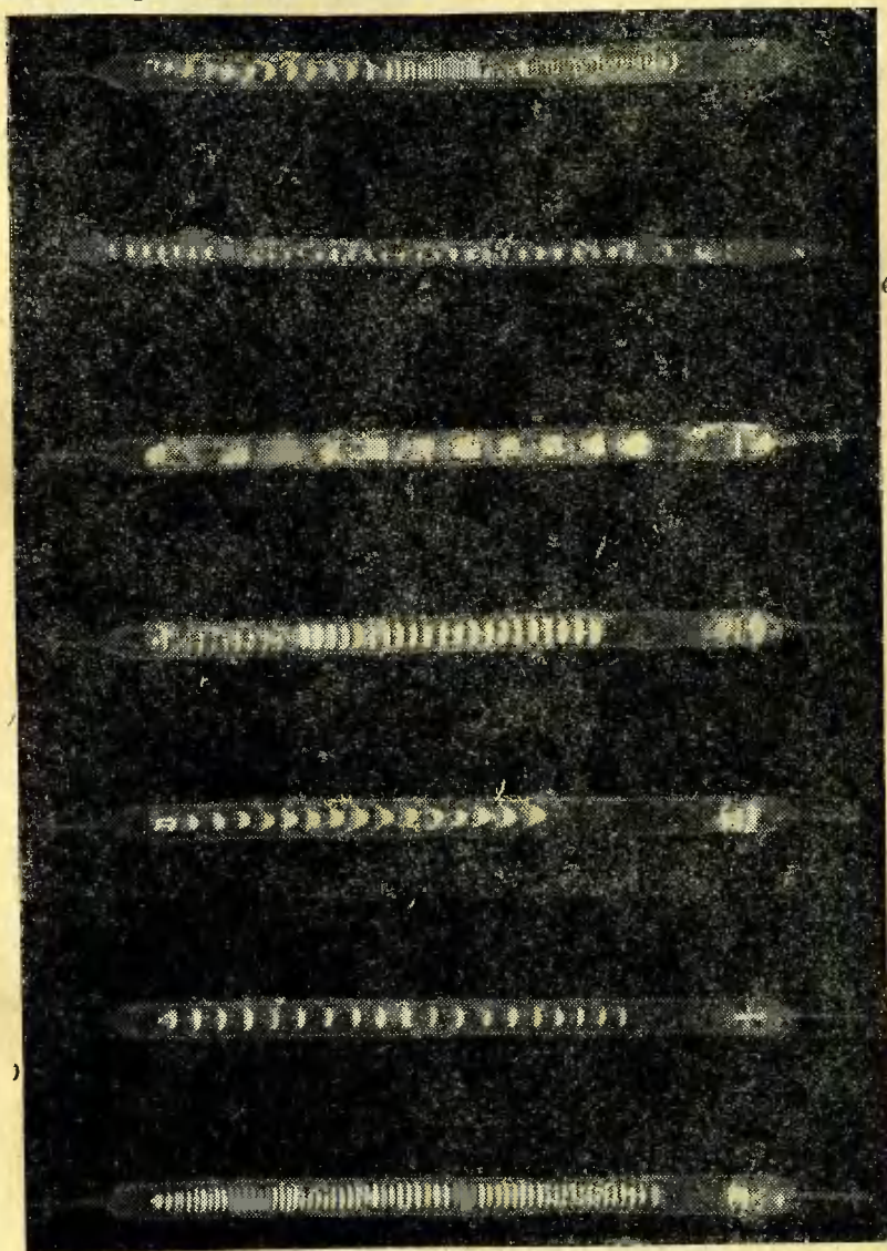
Рис. 205. Различные формы страт в слоистом положительном столбе.
