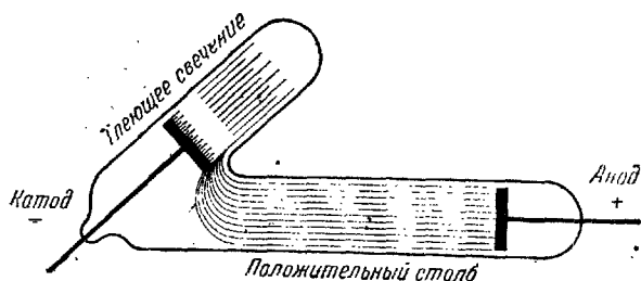
Рис. 192. Изменение расположения частей тлеющего разряда при изменении положения катода.
